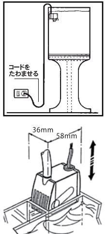
※本製品はスペースが限られた場所でも使用できるよう設計されています。吐出口と電源コードの接続部が同じ面に配置されており、図のような狭いスペースに設置することができます。
