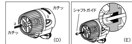
※NWA5900は、ポンプカバーを図Dのaの方向にはめ込んだ後、bの方向に回転させて固定してください。
