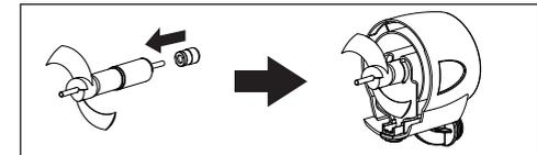
6. ポンプカバーを本体にカチッと音がするまではめ込み(図D)、ポンプ正面にシャフトガイドをまっすぐ差し込んで戻してください(図E)。
